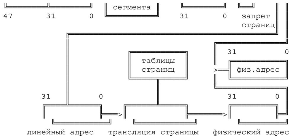
Селектор представляет собой индекс в таблице дескрипторов сегментов, т.е. это поле содержит номер сегмента. Каждый элемент таблицы дескрипторов сегментов содержит базовый адрес сегмента. Процессор добавляет к нему смещение и получает 32-битный линейный адрес. Если страницы не разрешены, процессор считает, что линейный адрес является физическим, и выдает его на адресные выходы.
